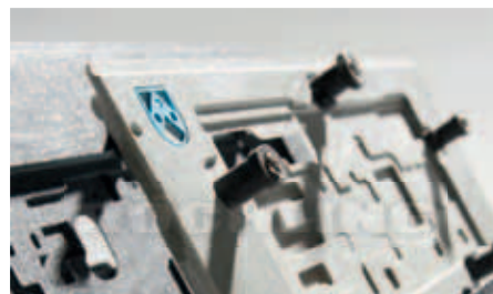
Masques de soudure pour le transport de circuits imprimés
