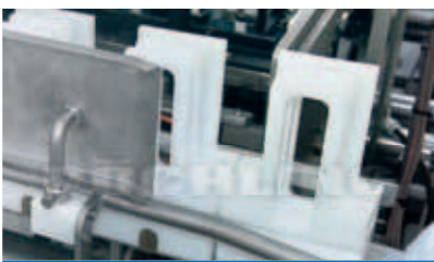
Éléments de transport dans une installation d'emballage pour les fromages au lait caillé (Harzer Käse)
