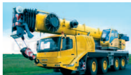
Grue avec élément de glissement dans la flèche
