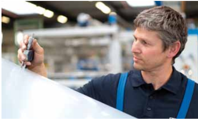
Kontrolle der Dicke: in Lahnstein gefertigte Platte aus dem weltweit renommierten Hochleistungskunststoff SUSTAPEEK
