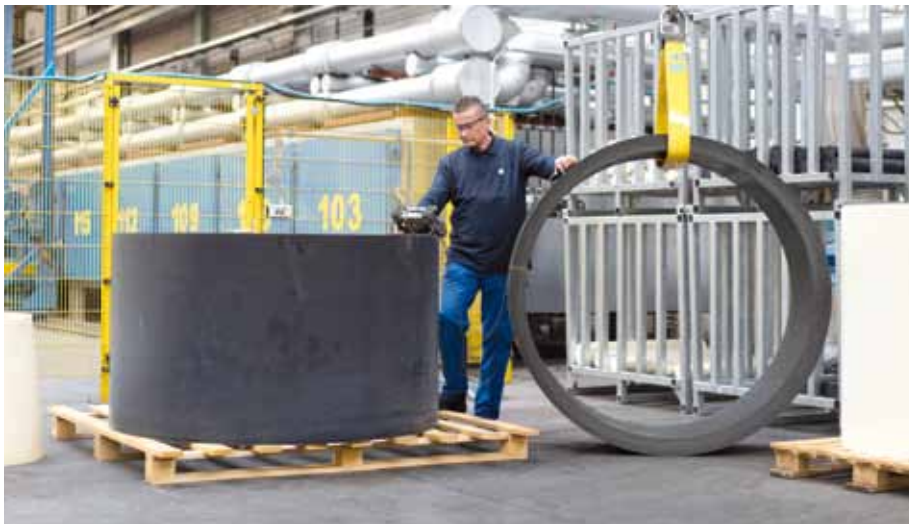
Formgussteil aus SUSTAMID: Röchling Sustaplast verfügt über eine der modernsten und größten Anlagen für die Verarbeitung von Gusspolyamid
