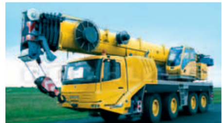
Kran mit Gleitelement im Ausleger
