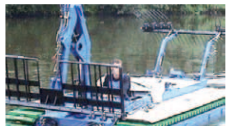
Mähboot zur Gewässerpflege mit Kunststoff-Bauteilen am Kettenantrieb
